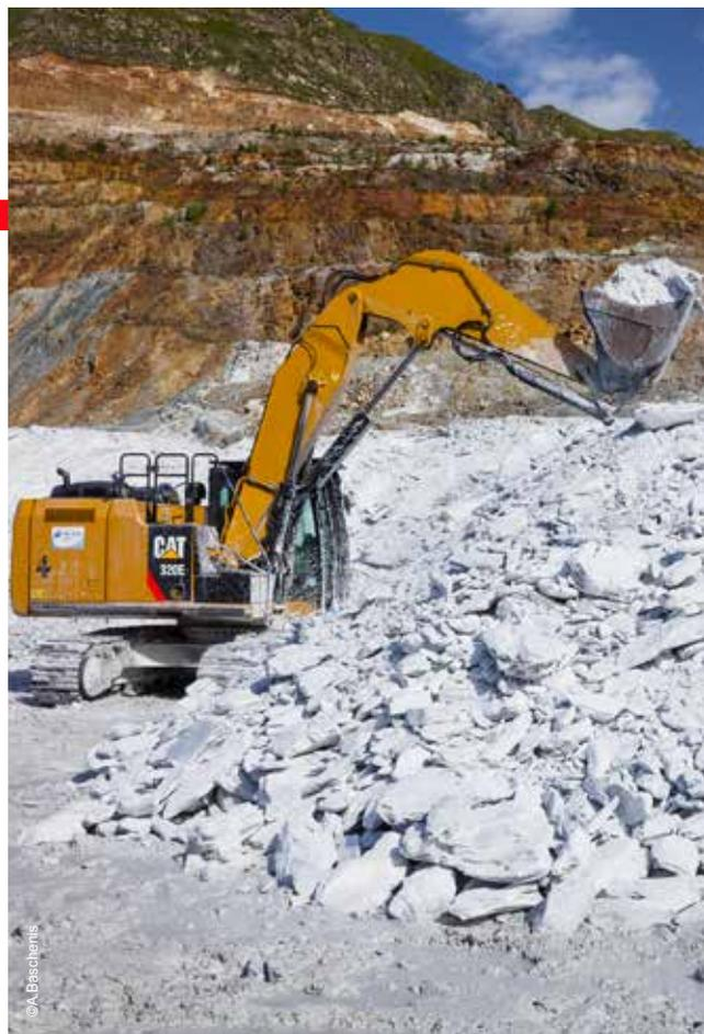
*“ La pelle utilisée pour charger ces dumpers possède un godet contenant jusqu'à 30 tonnes de roche ! ”*
